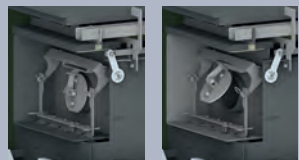
Rauchgasklappe geschlossen Rauchgasklappe geöffnet
