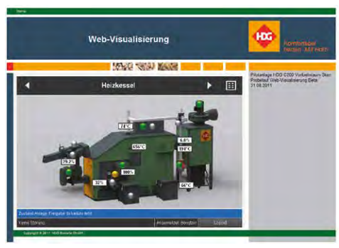
Per Mausclick die Heizanlage an den Bildschirm holen. Mit der HDG Web-Visualisierung ist dies jederzeit möglich.
