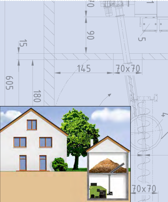
Beispiel: Siloaustragung aus einem Spänesilo mittels Schrägschnecken-Austragung
