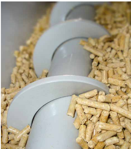
Die HDG Pellet-Austragungsschnecke fördert Pellets aus rechteckigen Lagerräumen.
