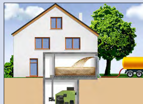
Beispiel: Pelletlagerraum mit Einblasvorrichtung
