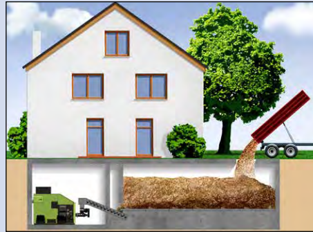
Beispiel: Schubboden-Raumaustragung mit Befüllung über befahrbare Decke
