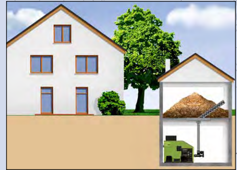
Beispiel: Siloaustragung aus einem Spänesilo mittels Schrägschnecken-Austragung
